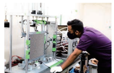
共同研究で実施している粒状材料の力学試験の様子 写真：本学博士後期1年 Ali Ushman さん
